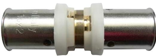
посадки трубы в фитинг. Уплотнение обеспечено двумя специальными уплотнительными кольцами. Для обжатия можно использовать пресс-клещи „TH“ или „B“.
